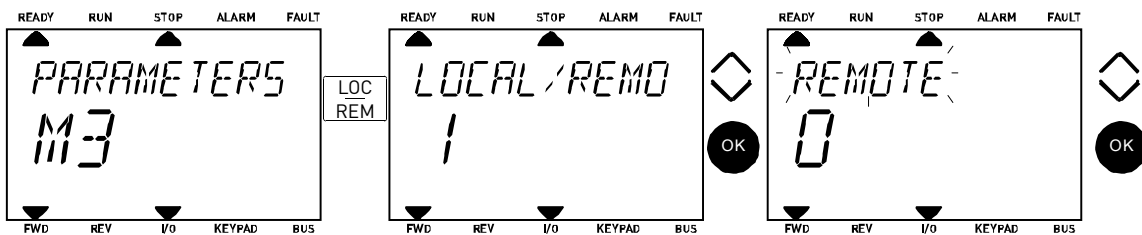
Figura 10. Cambio de los lugares de control
